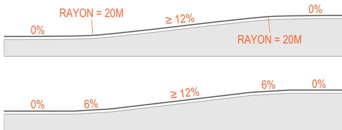
Figure 2. - Raccordements entre différents segments de rampes
