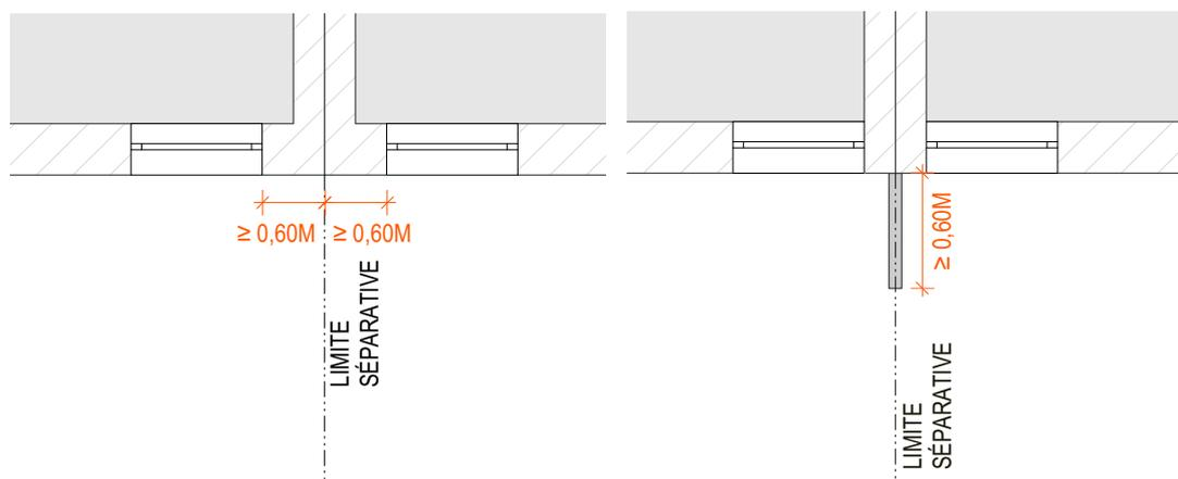
Figure 7. - Distance entre ouvertures et murs pare-vue
